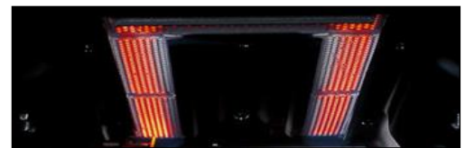
上火バーナ燃焼状態
