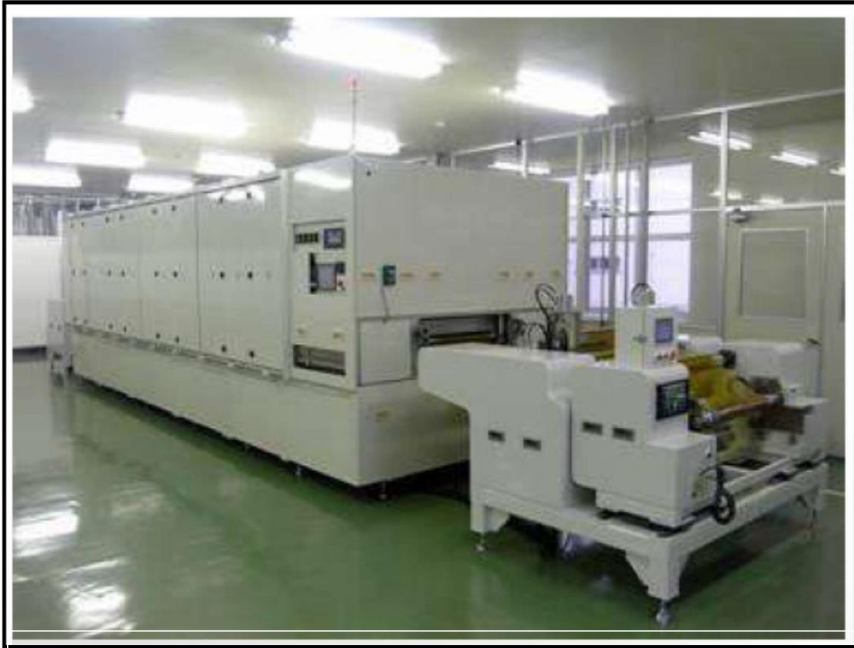
写真 1. 2 層 FCCL (銅張積層板) 用 R to R 式遠赤外線加熱装置
